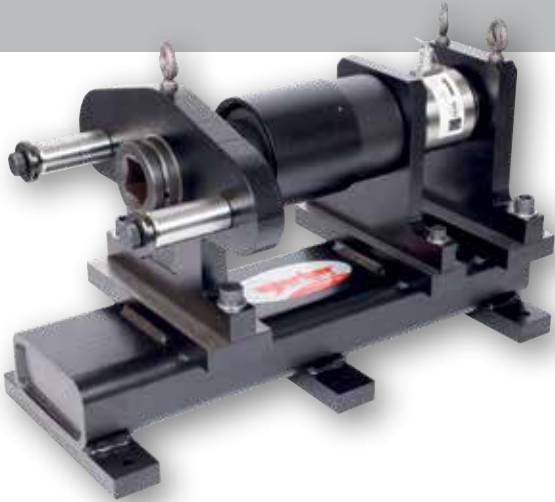
Elektrowerkzeug-Prüfvorrichtung, abgebildet mit 1½" M/F Statischer Messwertgeber (nicht enthalten)
