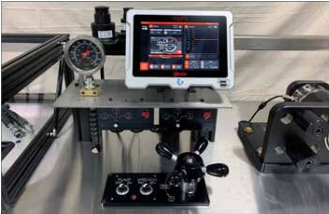
T-Box™ 2 in der Mitte eines Prüfstandes für hydraulische Drehmomentschlüssel
