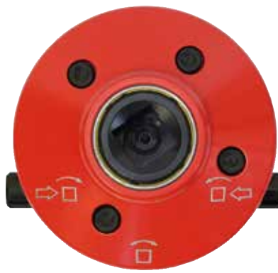
Einstellung Rücklaufsicherung Neutral.
