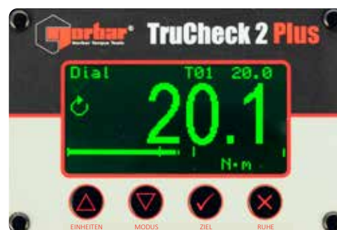
TruCheck™ 2 Plus mit Anzeige des Sollwertbereichs
