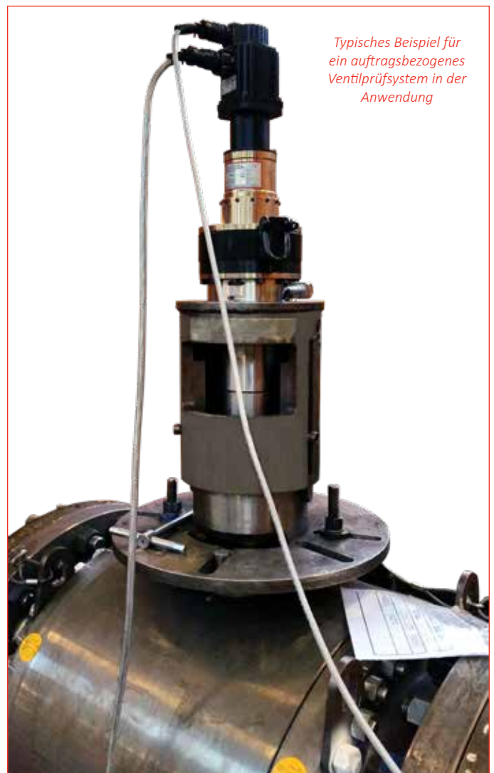
Beispiel für eine pneumatisch angetriebene PTS-72-1000 Fernsteuerung mit einem Drehmoment- und Winkelaufnehmer als Teil eines Ventilprüfsystems
