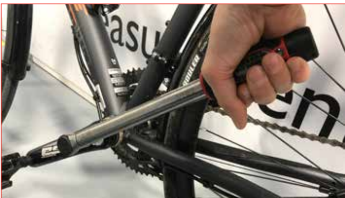
TTi50 Festziehen eines Pedals an einem Fahrrad
