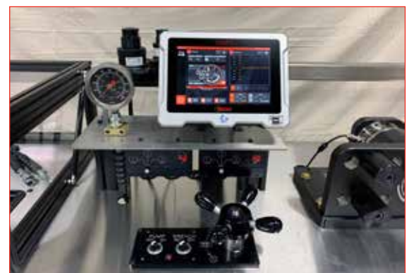
T-Box™ 2 in der Mitte eines Prüfstandes für manuelle Drehmomentschlüssel, angetriebene Drehmomentwerkzeuge und hydraulische Drehmomentschlüssel
