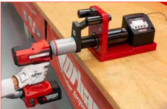
TruCheck™ 2 Plus 1100 abgebildet mit einem Elektrowerkzeug-Prüfadapter (nicht im Lieferumfang enthalten - siehe Seite 113), der eine kostengünstige Prüfung von Elektrowerkzeugen ermöglicht
