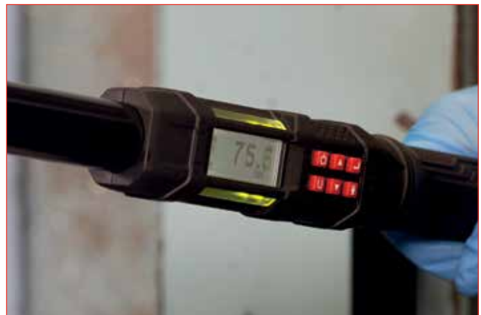
Zwei progressive LEDs auf beiden Seiten des Schlüssels bieten eine einfache visuelle Darstellung des Drehmomentfortschritts
