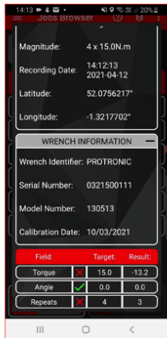
Anwendungs- und Werkzeuginformationen bieten eine umfassende Aufzeichnung für Rückverfolgungszwecke
