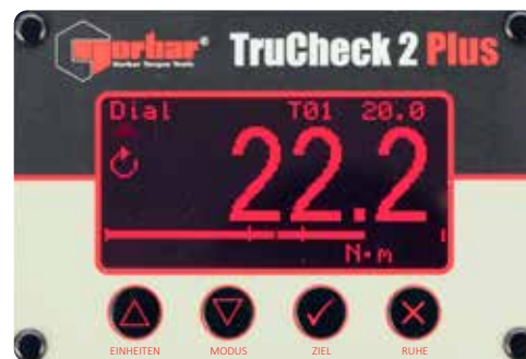
TruCheck™ 2 Plus mit Anzeige der Toleranz für Sollwertüberschreitung
