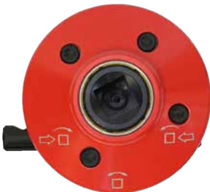
Einstellung Rücklaufsicherung gegen den Uhrzeigersinn.
