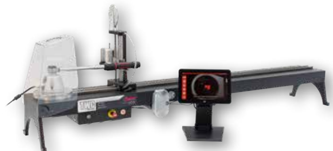
Drehmomentschlüssel-Kalibriervorrichtung Auto (TWC), hier dargestellt mit einem Professionellen Schlüssel, Modell 200 und einem angeflanschten Messumformer (nicht enthalten)
