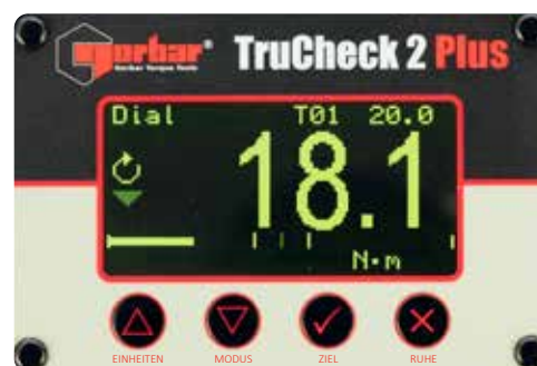
TruCheck™ 2 Plus mit Anzeige des Toleranz für Sollwertunterschreitung
