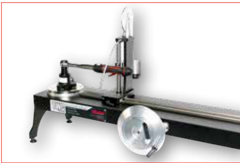
Drehmomentschlüssel-Kalibrator (TWC) Manuell dargestellt mit einem flanschmontierten Messwertgeber und einem Drehmomentschlüssel Modell 100 (nicht enthalten)
