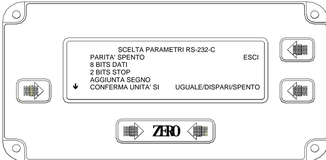
Selezionare il parametro desiderato premendo ripetutamente '↓' fino a quando lampeggia il testo voluto. Per cambiare la funzione la funzione, premere a fondo il pulsante di destra, che cambierà la sua azione quando ogni funzione è selezionata. Premere 'ESCI' quando tutte le selezioni sono state fatte.
