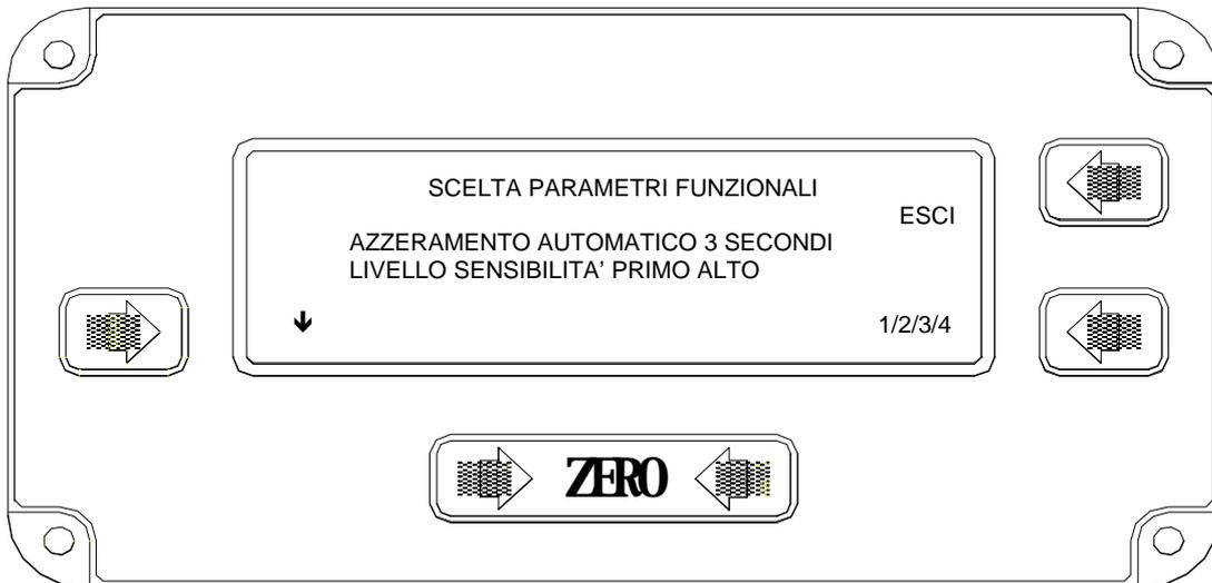
Selezionare il parametro funzionale desiderato premendo ripetutamente '↓' fino a quando lampeggia il test voluto. Per cambiare la funzione, premere a fondo il pulsante basso a destra, che cambierà la sua azione quando ogni funzione è selezionata. Premere 'ESCI' quando tutte le selezioni sono state fatte.
