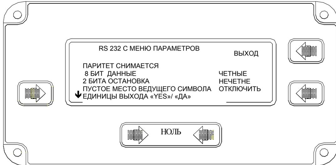
Повторным нажатием кнопки '↓' выберите нужный параметр. Чтобы изменить установку, нажмите кнопку в правом нижнем углу. Эта кнопка меняет функцию при выборе отдельного параметра. Когда выбор сделан, нажмите кнопку 'ВЫХОД'.
