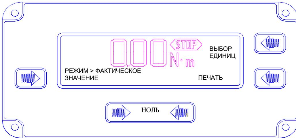
Для входа в режим 'НАСТРОЙКИ' одновременно нажмите кнопки 'ВЫБОР ЕДИНИЦ' & 'ПЕЧАТЬ', затем отпустите кнопки, после чего в течение 2 секунд высвечивается 'НОМЕР ПРОГРАММНОГО ОБЕСПЕЧЕНИЯ'.
