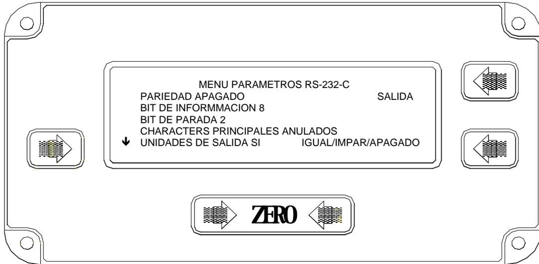
Seleccionar el parámetro deseado presionando repetidas veces '↓' hasta que parpadee. Para cambiar de parámetro apretar el botón de la derecha, este botón cambia su función a medida que seleccione cada parámetro. Cuando todos los parámetros hayan sido seleccionados presionar 'SALIDA'.
