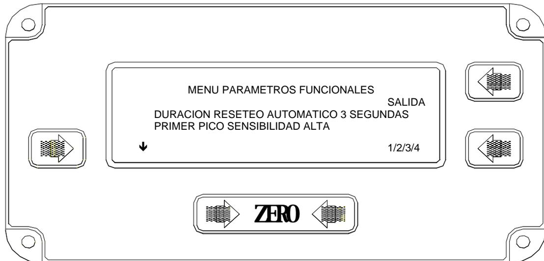
Seleccionar el parámetro deseado presionando repetidas veces '↓' hasta que el texto parpadee. Para cambiar el parámetro presionar el botón de la derecha, este botón cambia su función cuando se selecciona un parámetro cuando se han seleccionado todos los parámetros presionar 'SALIDA'.
