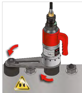
ABB. 7 – Entgegengerichtetes Drehmoment (Vorwärtsbetrieb)
