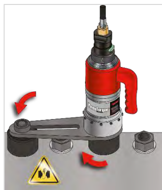
ILUSTRACIÓN 8 – Ejemplo de reacción en sentido contrario a las agujas del reloj ↺
