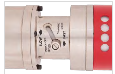
ILUSTRACIÓN 10 – Arriba, velocidad RÁPIDA Abajo, velocidad LENTA.
