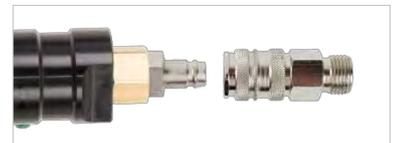
Branchez le côté d'admission de l'unité de commande de lubrification à l'alimentation pneumatique principale. Utilisez une conduite de 1/2" (12mm) minimum et d'une longueur maximale de 5m. (Des conduites plus longues diminueraient la performance de l'outil.).
