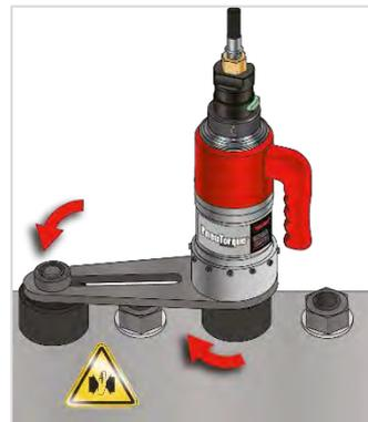
**FIGURE 8 – Exemple de réaction dans le sens inverse des aiguilles ↺**
