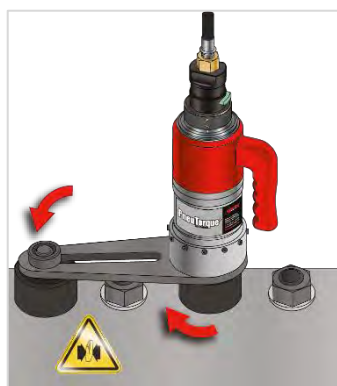
FIGURA 7 – Esempio di reazione in senso orario (FWD)
