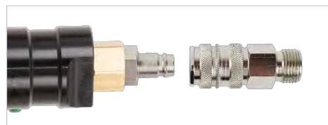
Ligue o lado de entrada da unidade de controlo de lubrificação ao fornecimento de ar principal. Utilize um tubo flexível com um furo mínimo de 12mm, com um comprimento máximo de 5m (os tubos flexíveis de comprimento superior reduzem o desempenho da ferramenta).
