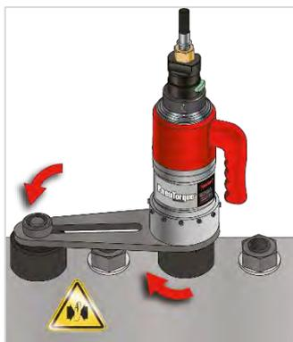
**SUGESTÃO: Para uma vida prolongada da ferramenta, certifique-se de que o ponto de reacção se encontra em posição perpendicular em relação ao multiplicador, para minimizar a tensão no dispositivo de saída. Se o multiplicador se inclinar sob carga, a reacção poderá não permanecer perpendicular.**
