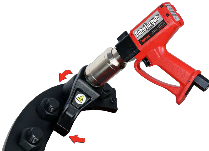
KUVA 9 – Kiinnittimen Avaaminen Myötäpäivään
