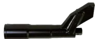
Il est impératif que la barre de réaction repose perpendiculairement sur un objet ou sur une surface solide proche de la fixation à serrer. La zone de contact doit se trouver dans la zone hachurée de la figure 2 et être la plus large possible.
