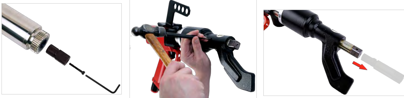
RYSUNEK 11 – Wymiana Kwadratu Napędowego
