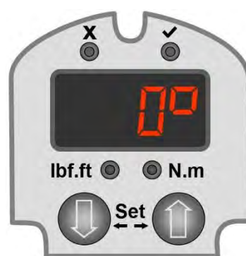
IMAGEM 5b – Exposição do ângulo da ferramenta
