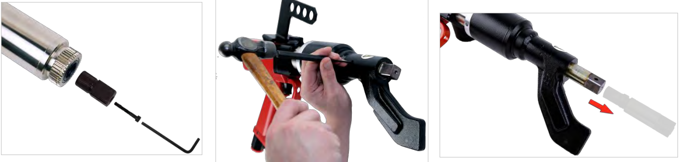
IMAGEM 11 – Substituição Do Dispositivo De Accionamento
