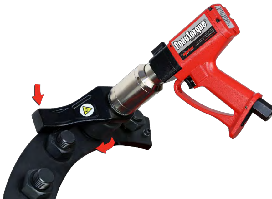
IMAGEM 8 – Apertar um Fixador no Sentido dos Ponteiros do Relógio
