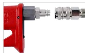
Collegare il lato di ingresso dell'unità di controllo della lubrificazione (figura 1-B) alla rete di fornitura dell'aria (figura 1-A) usando un tubo flessibile dal diametro minimo di 1/2" (12 mm).
