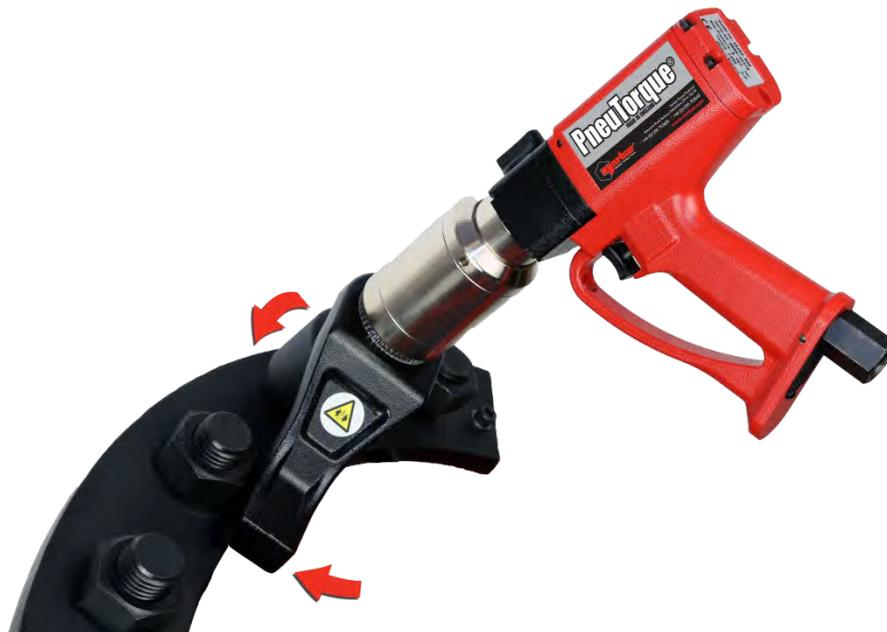
**FIGURA 13** – Allentare Il Fissaggio In Senso Orario
