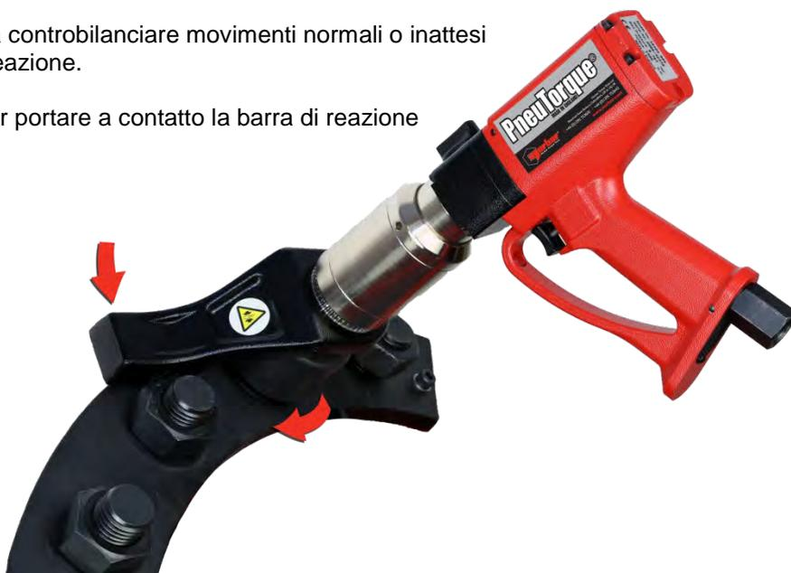
**FIGURA 12-** Stringere Il Fissaggio In Senso Orario
