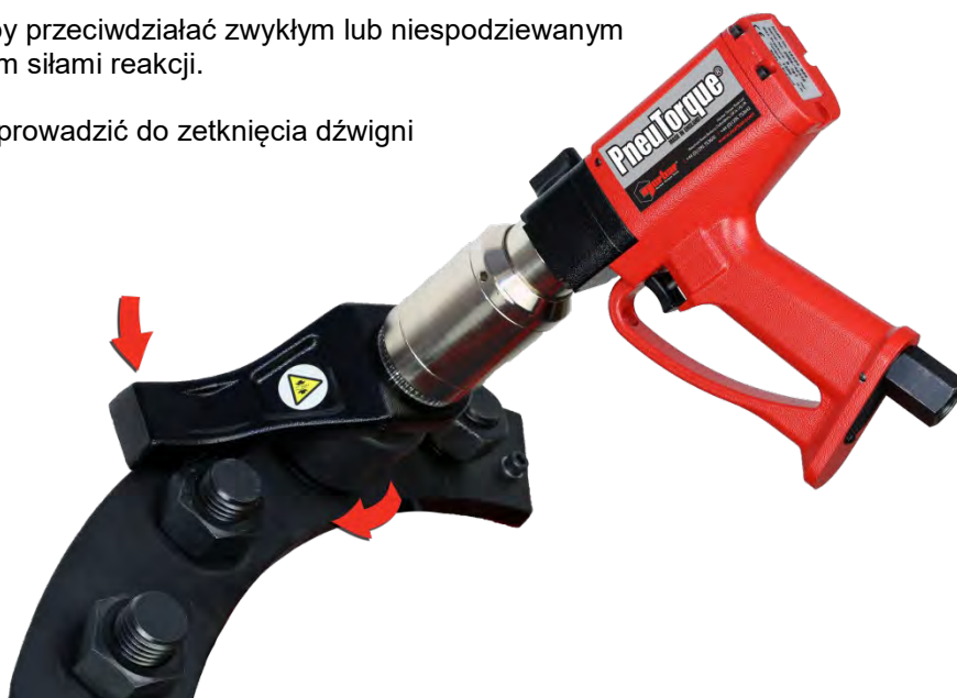
RYSUNEK 12- Dokręcanie łącznika Z Prawym Gwintem
