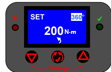
ABBILDUNG 23.b: DREHMOMENT & WINKEL einstellen
