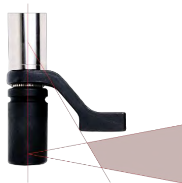
RYSUNEK 8 – Obszar bezpiecznej reakcji nasadki o zwiększonej długości
