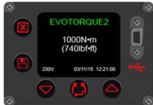
**FIGURA 43** – Visualización de la capacidad de la herramienta, la
