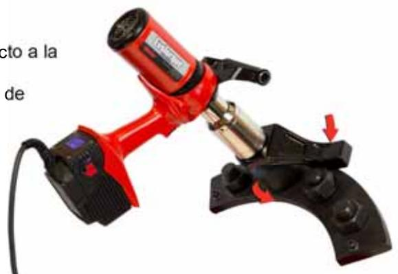
**FIGURA 55** -Funcionamiento en el sentido contrario de las agujas del reloj
