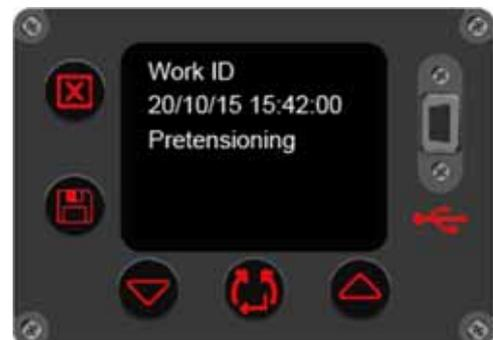
**FIGURA 38** – Visualización del identificador de trabajo
