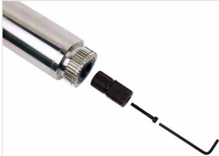
**FIGURA 56** – Sustitución del cabezal de transmisión cuadrado
