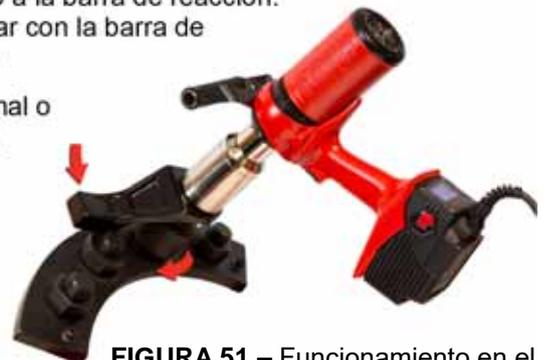
FIGURA 51 – Funcionamiento en el sentido de las agujas del reloj
