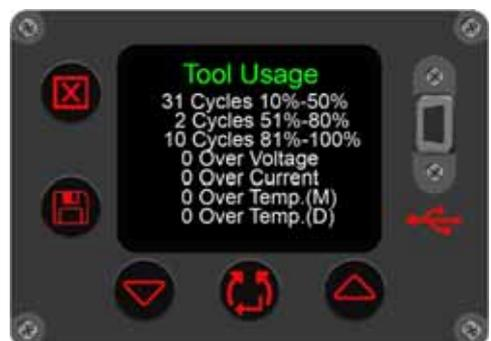
FIGURA 49 – Visualización del uso de la herramienta
