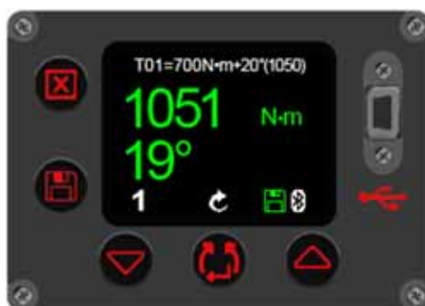
FIGURA 53 - Risultato del bersaglio di Coppia e Angolo (con Coppia finale) (indicato come verde per positivo)
