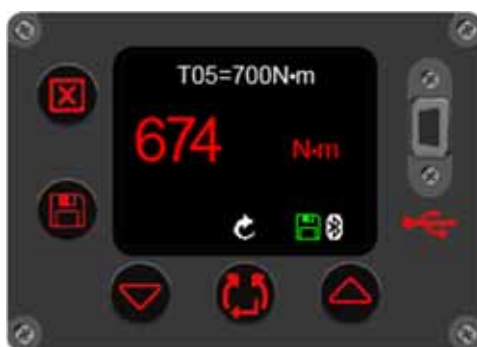
FIGURA 52 - Risultato target coppia (colore rosso per fail)
