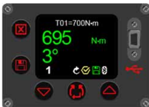
FIGURA 54 - Risultato target coppia di verifica (che mostra la coppia ottenuta e il movimento del bullone in gradi)
