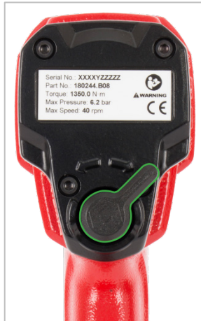
Abb. 7(a) – Vorwärts (Hebel zeigt nach rechts)
