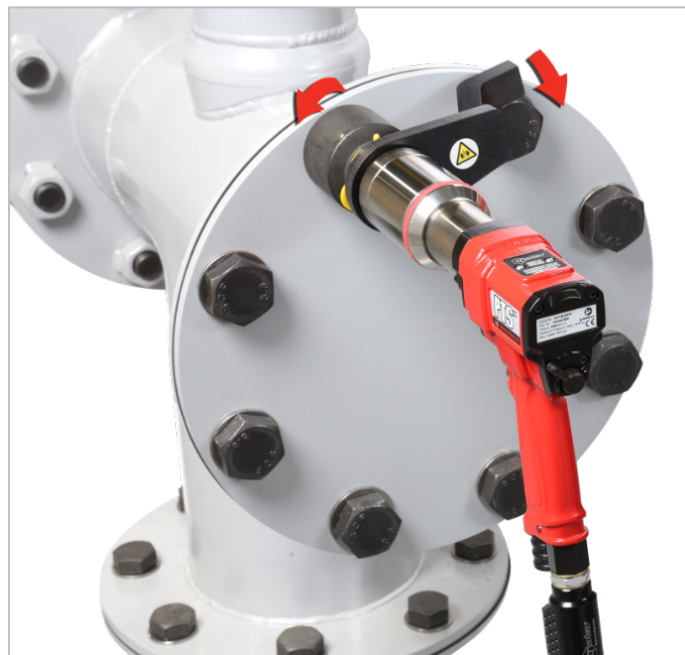
ABB. 9 – Betrieb gegen den Uhrzeigersinn
