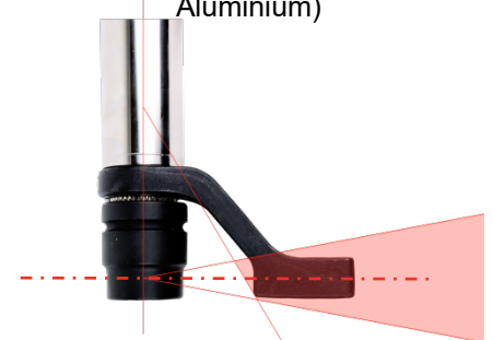
ABBILDUNG – Sicheres Stützfenster bei Fassungen in Standardlänge
