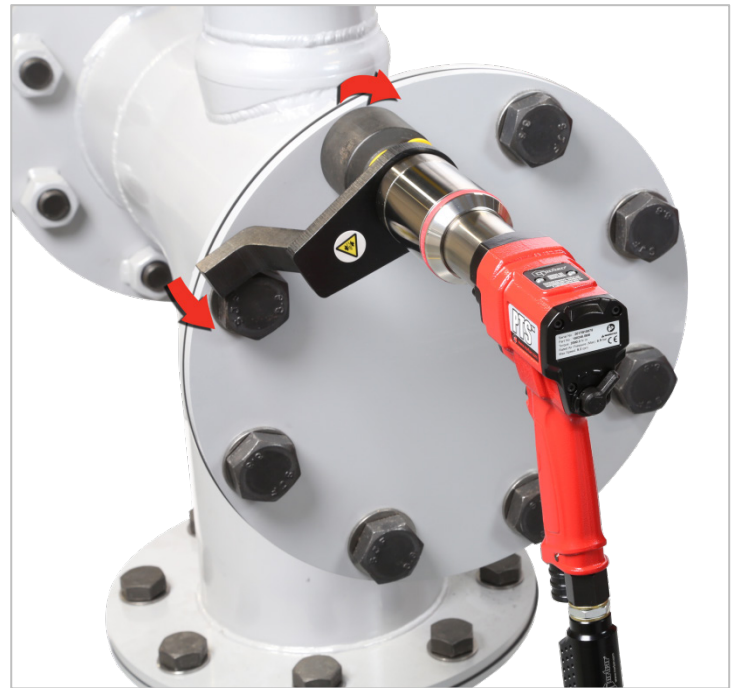
ABB. 8 – Betrieb im Uhrzeigersinn
