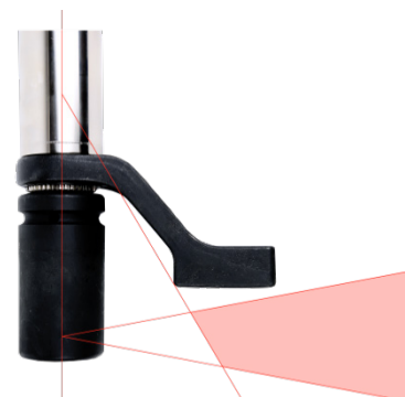
ABBILDUNG 4 – Sicheres Stützfenster bei extra langen Fassungen
