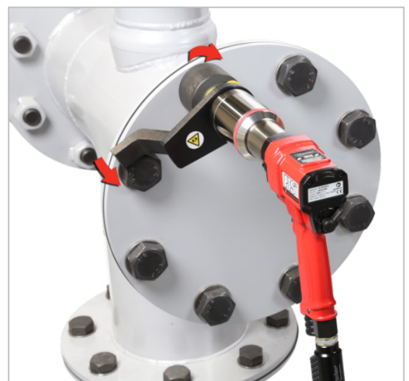
ILUSTRACIÓN 8 – Funcionamiento en el sentido de las agujas del reloj
