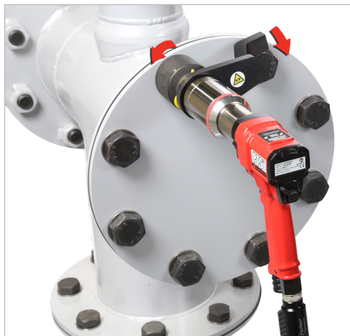
FIGURA 9 – Funcionamento no sentido anti-horário
