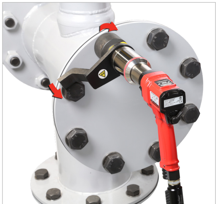
FIGURA 8 – Funcionamento no sentido horário
