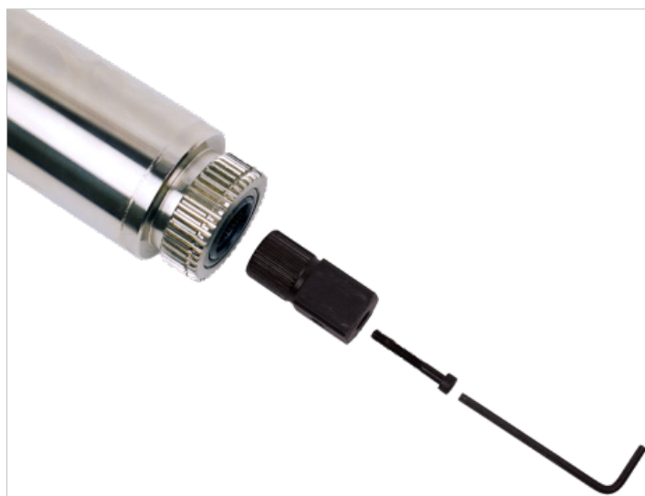
FIGURE 12 - Remplacement du carré d'entraînement
