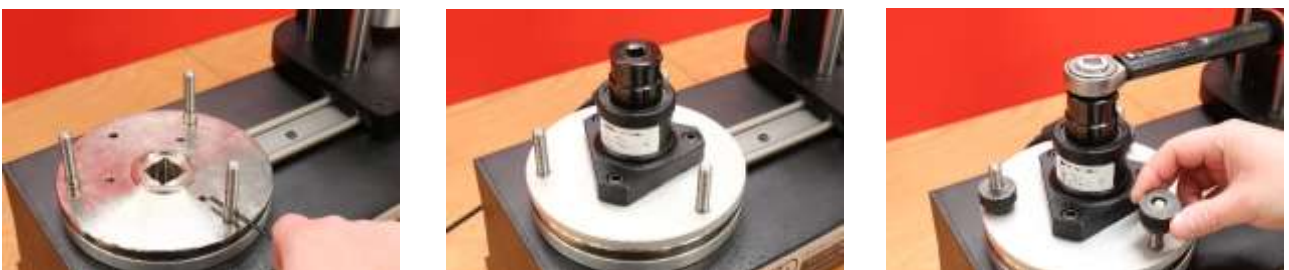
FIGURA 31 - Colocación del kit de liberación rápida del FMT
