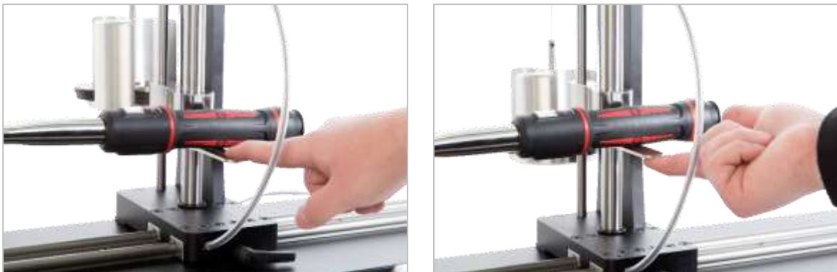
FIGURA 18 - Asegurar que la llave dinamométrica esté en posición horizontal
