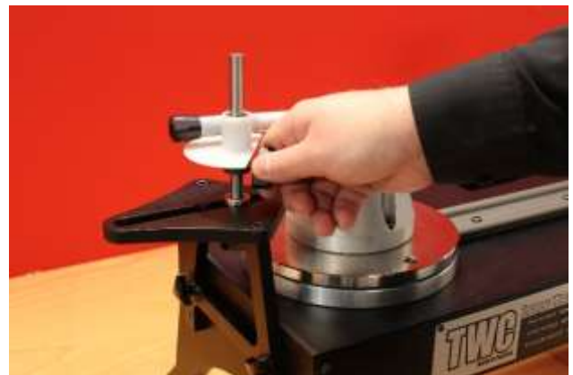
FIGURA 29 – Ajuste del punto de reacción de las placas de reacción corta
