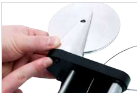
FIGURA 10 - Colocación de la rueda de reacción de contrapeso
