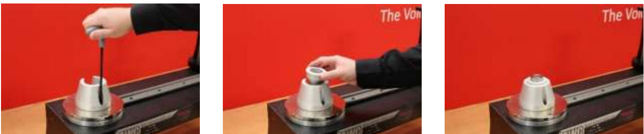
FIGURA 27 – Montaje del kit de soporte del transductor estático.
