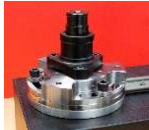
FIGURA 32 - Colocación de la placa de ángulo de desfase del TWC
