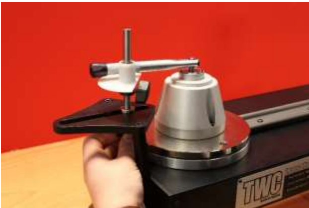
FIGURA 29 – Ajuste del punto de reacción de las placas de reacción corta
