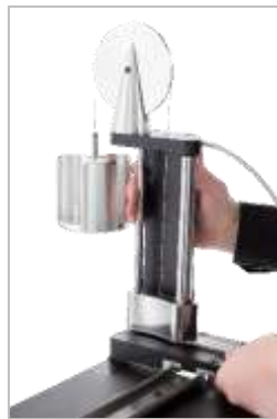
FIGURA 12 - Cómo deslizar el conjunto de reacción de contrapeso en el riel de reacción
