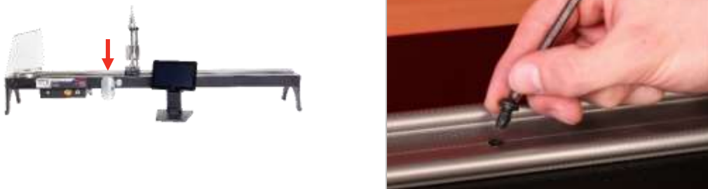
FIGURA 21 - Retiro del tornillo de cabeza de botón
