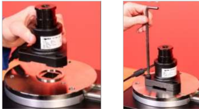
FIGURA 14 - Montaje de un transductor montado sobre bridas
