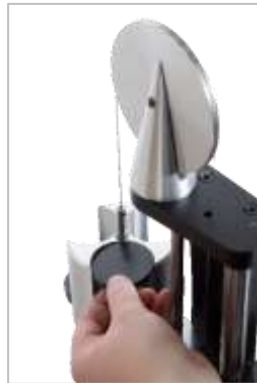
FIGURA 17 - Adición de pesas al conjunto de contrapeso de reacción.
