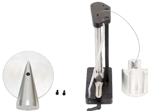
KUVA 8 – Purettu Keventimen Vastavoimapylväs
