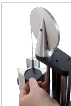
KUVA 17 – Painojen lisääminen keventimen vastavoimarakenteeseen
