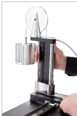
KUVA 12 – "Keventimen Vastavoimapylväsrakenteen" Liu'uttaminen Voimakiskoon
