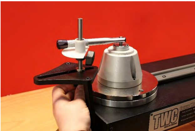
KUVA 29 – Lyhyen Vastavoimalevyn Voimapisteen Säätäminen
