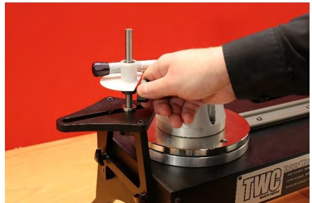
KUVA 29 – Lyhyen Vastavoimalevyn Voimapisteen Säätäminen
