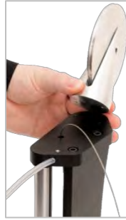
FIGUUR 9 - Het Tegenwichtwiel Opstellen
