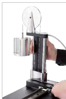
FIGUUR 12 - Schuiven Van De Tegenwichtreactie-Inrichting Op De Reactierail
