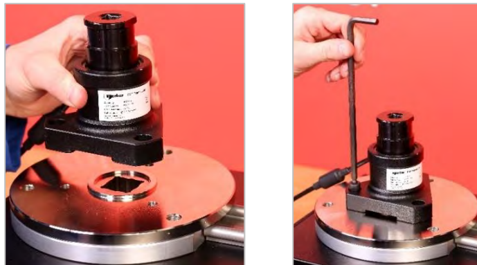
BILD 14 – Montering Av En FMT-Transducer
