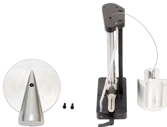
BILD 8 – Demontering Av Balansställning
