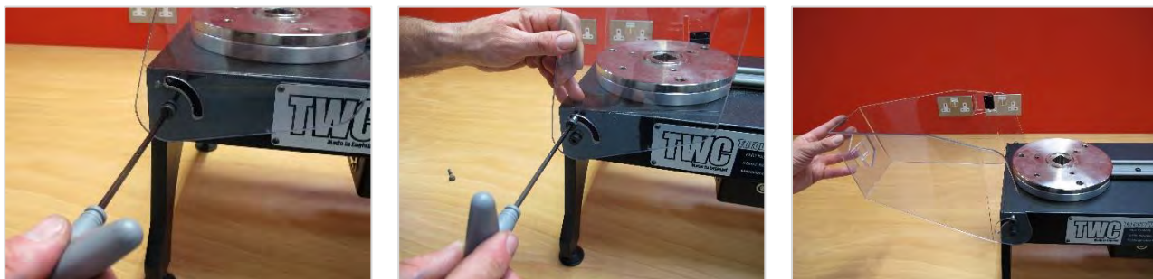
BILD 7 – Montering Av Skydd
