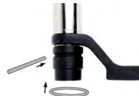
**FIGURE 16** - Fixation de la douille
