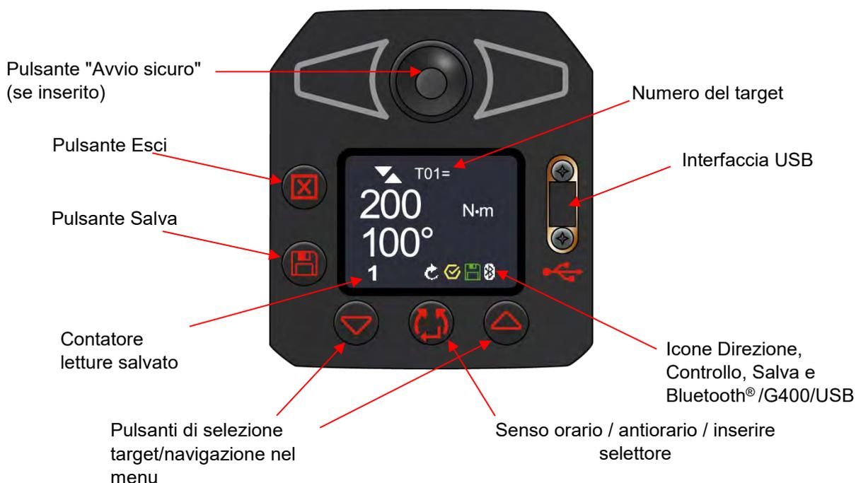
**FIGURA 2 - Caratteristiche dell'interfaccia utente**
