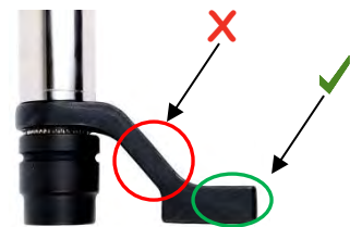
AFBEELDING 6 – gebogen reactiebalk (staal of aluminium)
