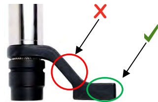
FIGURA 6 – Barra de Reação com Rotação (Aço ou Alumínio)
