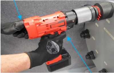
7. Drücken Sie den Auslöser ganz durch, bis das Werkzeug stoppt, und lassen Sie ihn dann los.
