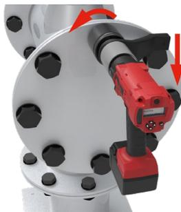
4. Adopta una postura para neutralizar el movimiento normal o cualquier movimiento inesperado de la herramienta debido a las fuerzas de reacción.
