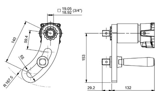
2. Instala la barra de reacción sobre el cuadradillo de arrastre para acoplarlo a las ranuras de reacción. Sujétala con la arandela de sujeción proporcionada.
