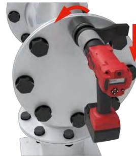
4. Adoptez une position permettant de contrer le mouvement normal ou inattendu de l'outil dû aux forces de réaction.
